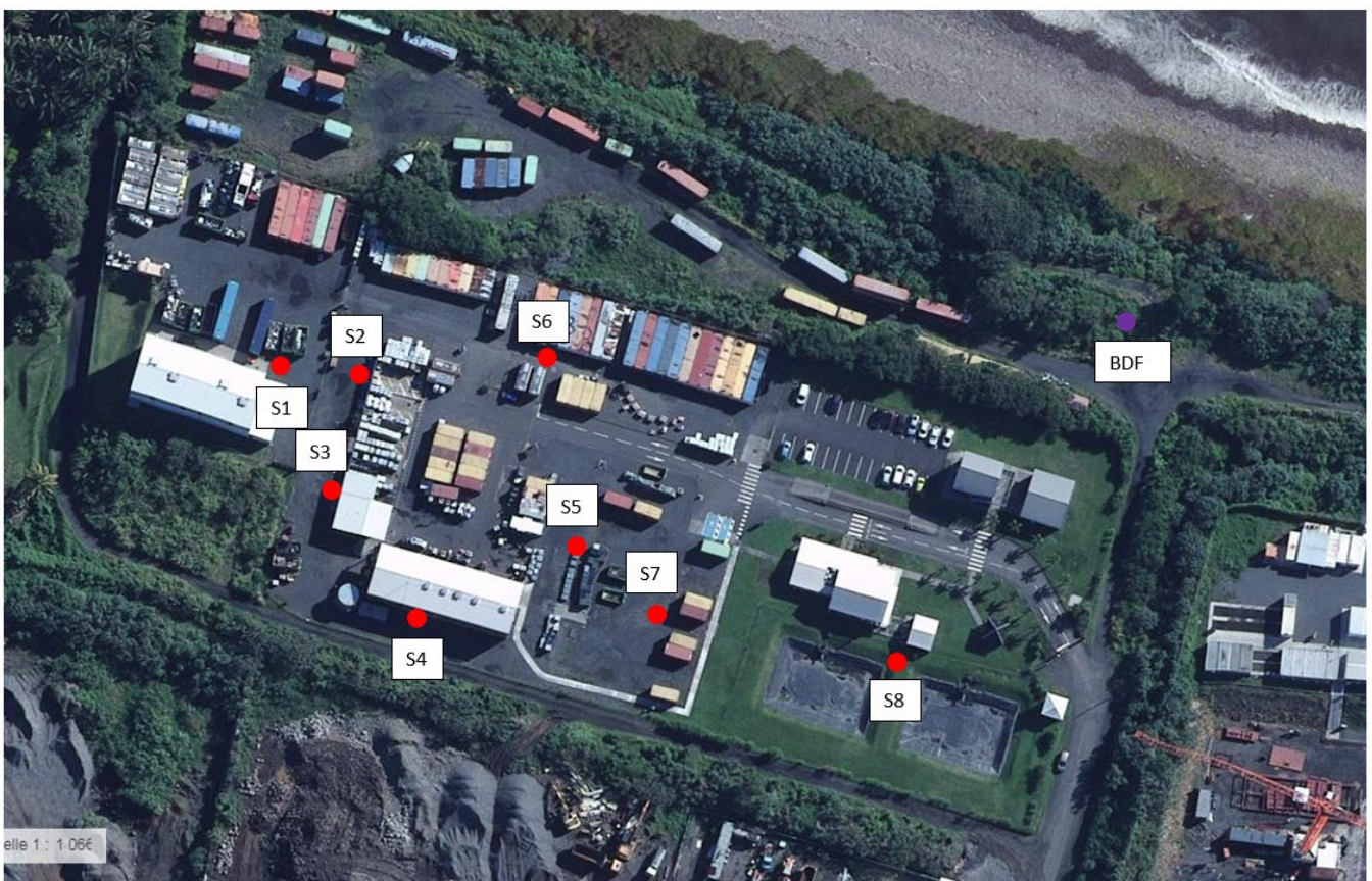
Figure 1 : Localisation prévisionnelle des sondages de sol
